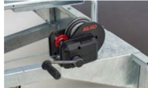
Winde mit Windenstütze
